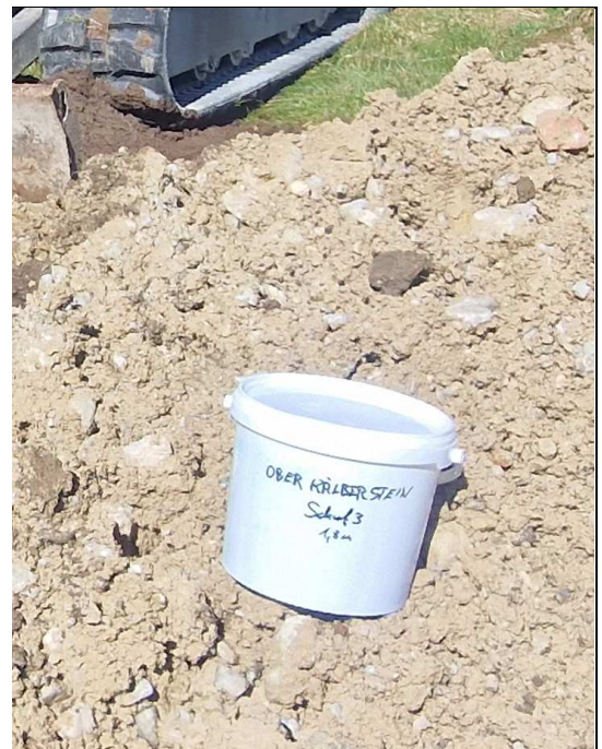
Abbildung 6: Foto Bodenaufschluss Schurf Nr. 3 mit Benennung der angetroffenen Bodenschichten und Bodenprobe 2
