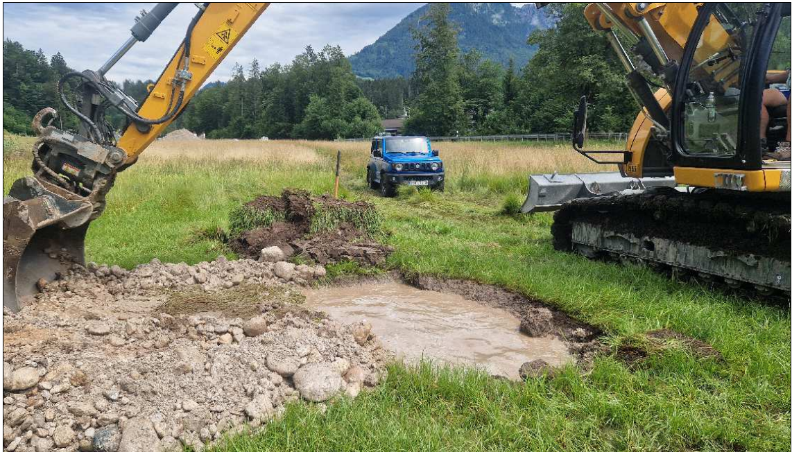
Abbildung 2: Extrem hoher Grundwasserstand im Schurf 3 – bei Niedrigwassersituation
