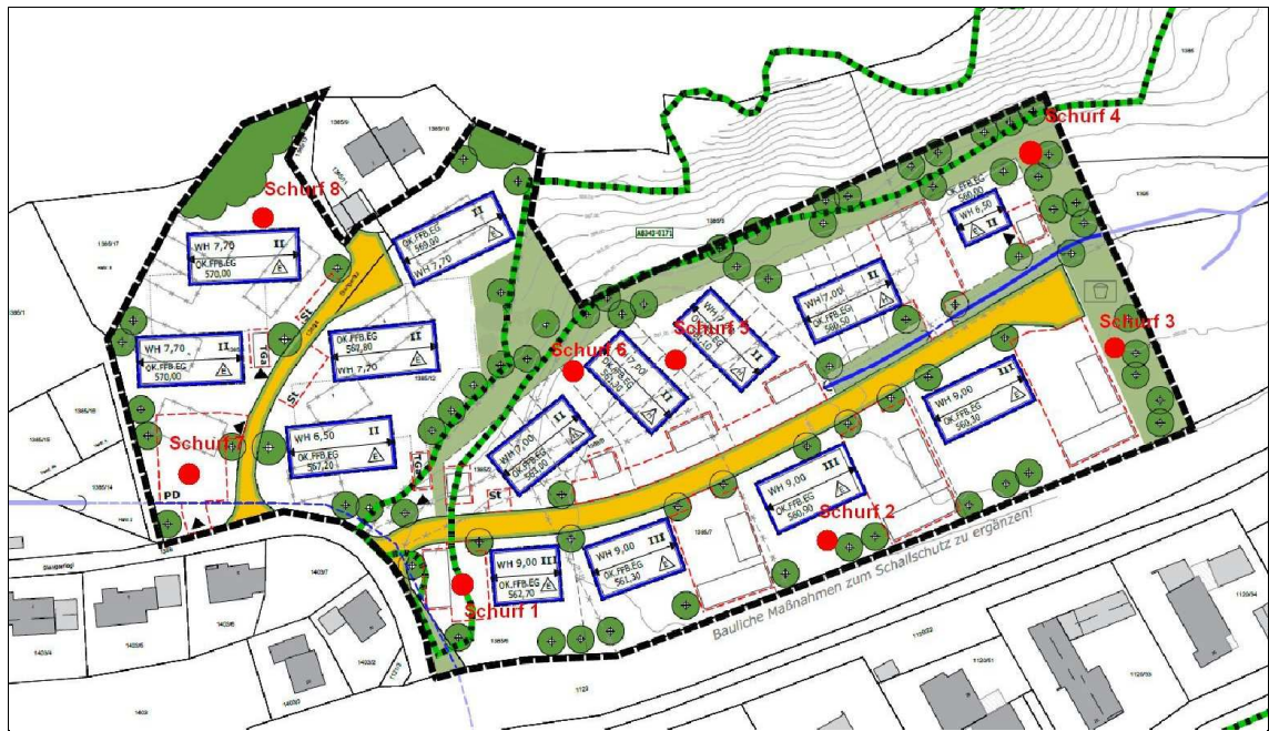
Abbildung 12: Lageplan mit den Bodenaufschlüssen Schurf 1 bis Schurf 8
