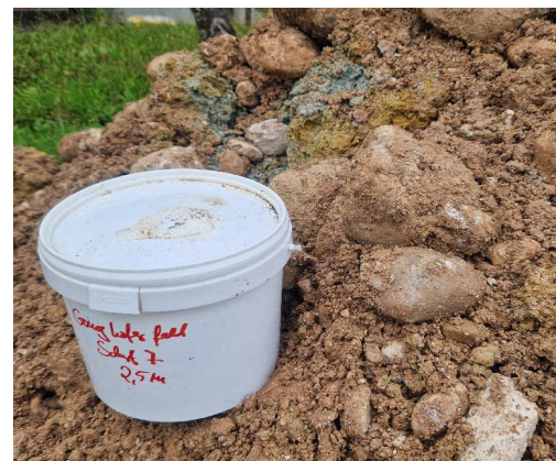
Abbildung 19: Foto Bodenaufschluss Schurf Nr. 7 mit Benennung der angetroffenen Bodenschichten und Bodenproben 4 und 5
