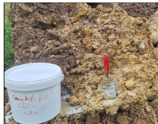
Abbildung 18: Foto Bodenaufschluss Schurf Nr. 6 mit Benennung der angetroffenen Bodenschichten und Bodenprobe 3
