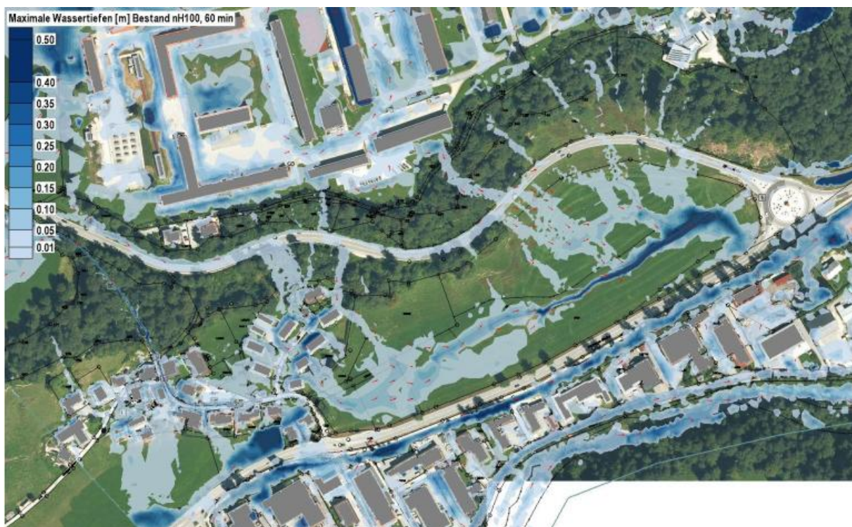
Abb. 19 Wild abfließendes Oberflächenwasser im Bestand
