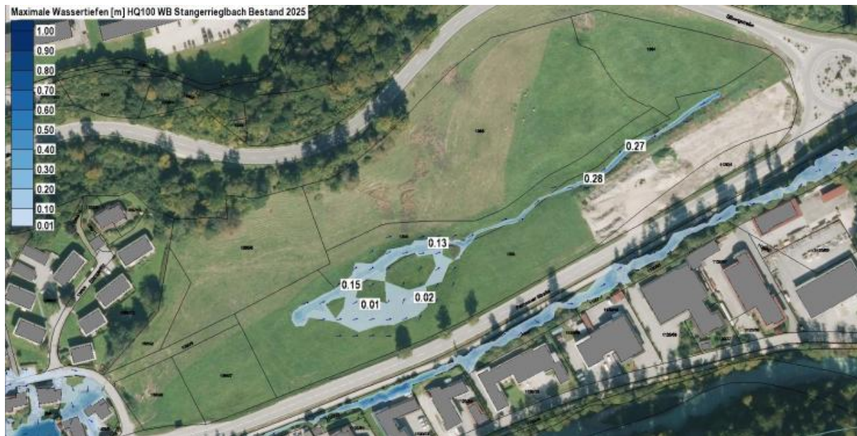
Abb. 20 Fließtiefen durch Rückstau im Bestand
