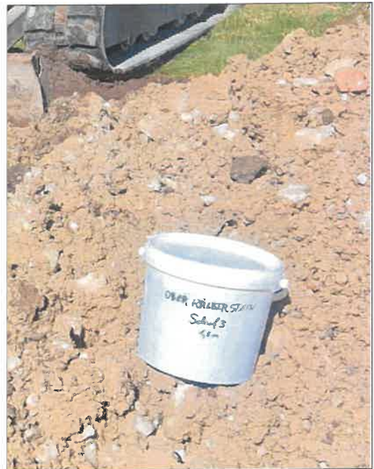
Abbildung 6: Foto Bodenaufschluss Schurf Nr. 3 mit Benennung der angetroffenen Bodenschichten und Bodenprobe 2
